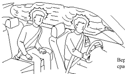
Боковые подушки безопасности срабатывают только с той стороны, на которую пришелся удар.
